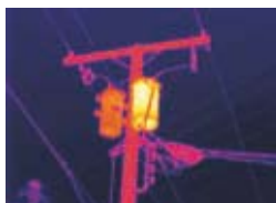
Přehřívání venkovních transformátorů
