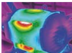
Abnormální/nerovnoměrné zahřívání motoru
